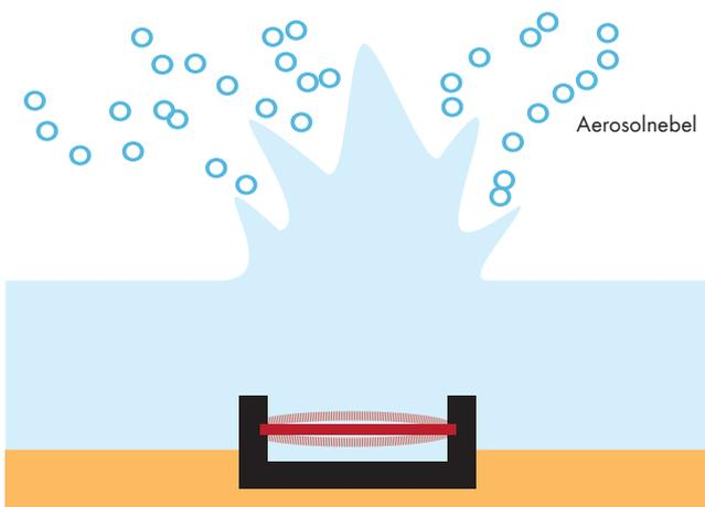
Der UB/P-D ist mit dem Hygienemanagement AquaDrain ausgestattet und daher für hochstehende hygienische Applikationen besonders geeignet. AquaDrain ist eine Einrichtung, welche die Wasserzulaufleitung nach diversen Parametern spült und die Wasserwanne des UB/P-D Befeuchters mittels einer softwaregesteuerten Magnetventil-Kombination zyklisch entleert.
